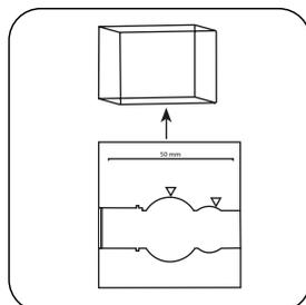
Prelevare la **cuvetta** dal vano di misurazione.
