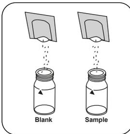
Immettere **una bustina di polvere Vario Silica Citric Acid F10** in ogni cuvetta.
