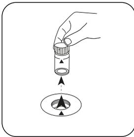
Prelevare la cuvetta dal vano di misurazione.
