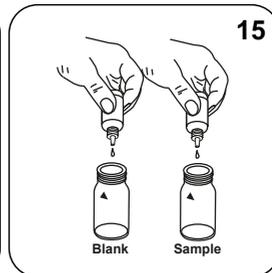
Immettere **15 gocce di soluzione Vario Molybdate 3 Reagenz-** in ogni cuvetta.
