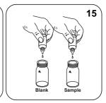
Dans chaque cuvette, versez 15 gouttes de solution Vario Molybdate 3 Reagenz-.
