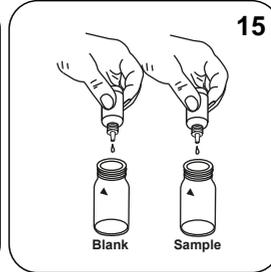
在每个比色杯中加入 15 滴 Vario Molybdate 3 Reagenz- 溶液。
