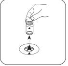
Prelevare la cuvetta dal vano di misurazione.
