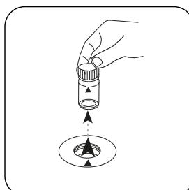
Prelevare la cuvetta dal vano di misurazione.
