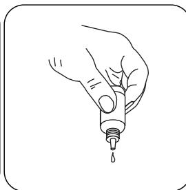
将 Hardness Calcium Buffer CH2滴加到相同的样本中，直到出现淡粉色向红色转变。（注意：滴加后摇动样本！）
