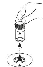
Retirez la cuvette de la chambre de mesure.
