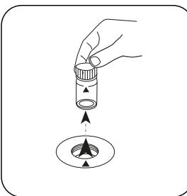
Prelevare la cuvetta dal vano di misurazione.
