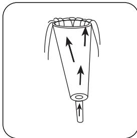
Dejar circular el agua de test de abajo a arriba durante varios minutos en el recipiente de toma de muestras, para eliminar las burbujas de aire.
