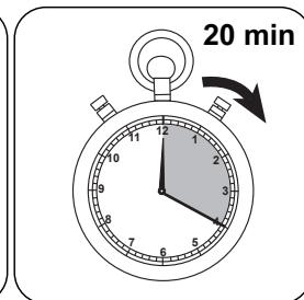
Die Probe für **20 Minuten kochen**. Ein Probevolumen von 25 mL sollte beibehalten werden, gegebenenfalls mit VE-Wasser auffüllen.
