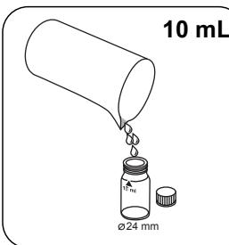
24-mm-Küvette mit **10 mL vorbereiteter Probe** füllen.
