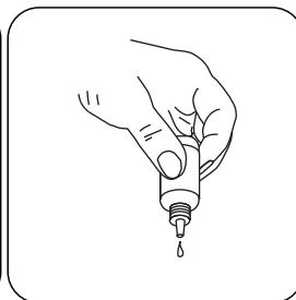
**Hardness Calcium Buffer CH2** druppelgewijs aan hetzelfde staal toevoegen tot een licht roze tot rode kleur ontstaat. (**Opgelet: het staal na elke druppel draaien!**)
