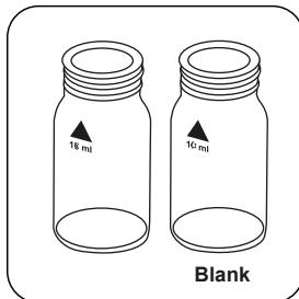
Preparare due cuvette pulite da 24 mm.
