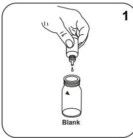
将 1 滴 Vario ALUMINIUM ECR Masking Reagent 加入到空白比色杯中。
