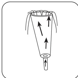
Gedurende enkele minuten testwater van onder naar boven door de staalfnamebeker laten stromen om luchtbellen te verwijderen.
