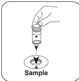
Posizionare la **cuvetta del campione** nel vano di misurazione.
