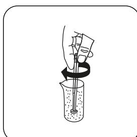
Pulver durch Rühren lösen. Taste **ENTER** drücken.
