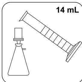
Filtrar cerca de 14 mL de amostra com um filtro pré-enxaguado (dimensão dos poros 0,45 µm).
