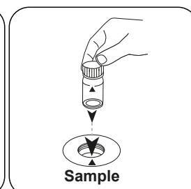
Die Probenküvette in den Messschacht stellen.
