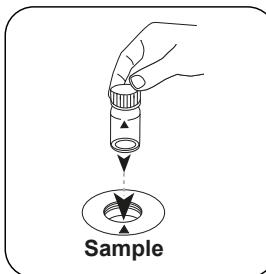
Die Probenküvette in den Messschacht stellen.
