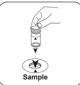
Posizionare la **cuvetta del campione** nel vano di misurazione.
