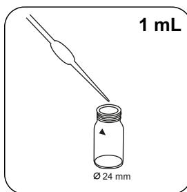
Añadir **1 mL de solución (25 drops) Polyacrylate Buffer A1** en la cubeta de muestra.
