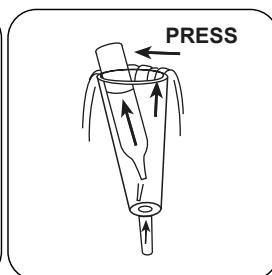
将 Vacu-vial® 安瓿放入取样容器中。轻轻按压容器壁，折断安瓿尖端。等待安瓿完全充满。
