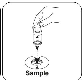
Die **Probenküvette** in den Messschacht stellen.
