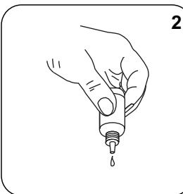
**2 druppels KS135 (Phenolphthalein Substitute Indikator)** toevoegen.
