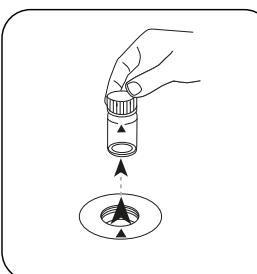
Prelevare la cuvetta dal vano di misurazione.
