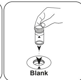
Posizionare la cuvetta **zero** nel vano di misurazione.
