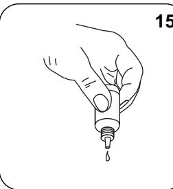
Adicionar **15 gotas KS278 (50% ácido sulfúrico)**.
