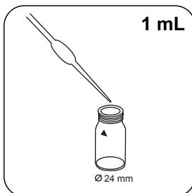
Ajoutez **1 mL de solution (25 drops) Polyacrylate Buffer A1** dans la cuvette réservée à l'échantillon.
