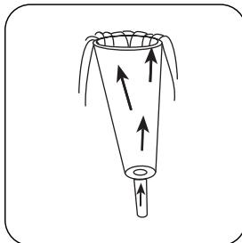
Mettez plusieurs fois le tube d'échantillon à l'envers et à l'endroit pendant quelques minutes pour mélanger l'eau test et éliminer les bulles d'air.
