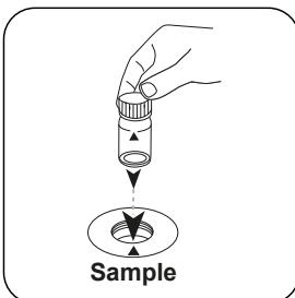
Placez la cuvette réservée à l'échantillon dans la chambre de mesure.
