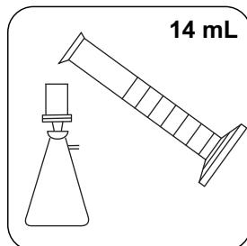
Filtrare circa **14 mL** di campione con un filtro precedentemente risciacquato (diametro pori  $0,45 \mu\text{m}$ ).
