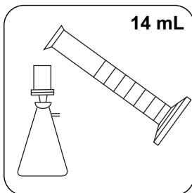
Etwa 14 mL Probe mit einem vorgespülten Filter (Porenweite 0,45 µm) filtrieren.
