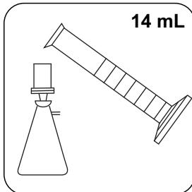
Filtrar unos 14 mL de muestra con un filtro prelavado (porosidad 0,45 µm).
