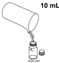
Remplissez une cuvette de 24 mm de **10 mL** d'échantillon préparé.
