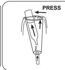
Placez une ampoule Vacu-vial® dans le tube de réactif. Brisez la pointe de l'ampoule en pressant légèrement contre la paroi du tube. Patientez jusqu'à ce que l'ampoule soit pleine.
