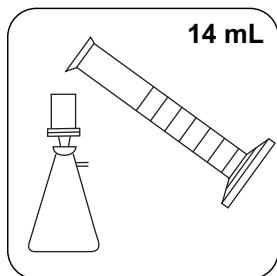
用预清洗的过滤器 (孔径 0.45μm) 过滤大约 14 mL 的样本。
