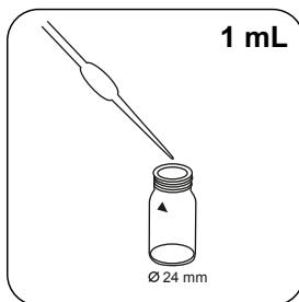
Introdurre **1 mL** di soluzione (25 drops) **Polyacrylate Buffer A1** nella cuvetta del campione.
