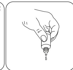
Adicionar **Hardness Calcium Buffer CH2** gota a gota da mesma amostra até aparecer uma coloração ligeiramente rosa a avermelhada. (**Atenção:** assim que adicionar cada gota, agite a amostra!)
