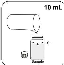
**10 mL Probe** in die Probenküvette geben.
