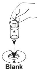
Placez la **cuvette du blanc** dans la chambre de mesure. Attention à la positionner correctement.
