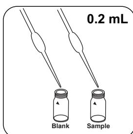
Immettere **0.2 mL di soluzione Vario DEHA 2 Rgt** in ogni cuvetta.
