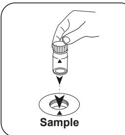
Die **Probenküvette** in den Messschacht stellen.
