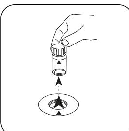
Prelevare la cuvetta dal vano di misurazione.
