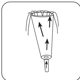
Probenahmegeräß mehrere Minuten von unten nach oben mit Testwasser durchstömen lassen, um Luftblasen zu entfernen.
