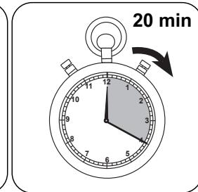
Mettez l'échantillon à ébullition et **maintenez la température pendant 20 minutes**. Il est recommandé de conserver un volume d'échantillon de 25 mL ; faites éventuellement l'appoint avec de l'eau déminéralisée.
