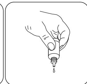
Ajoutez au goutte à goutte Hardness Calcium Buffer CH2 au même échantillon jusqu'à obtention d'une coloration rosée à rouge. (**Attention : agitez l'échantillon après chaque goutte ajoutée !**)
