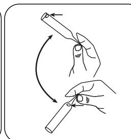
Die Ampulle mehrfach umschwenken.
