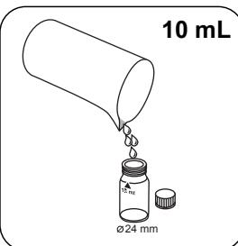
Riempire una cuvetta da  $\varnothing 24 \text{ mm}$  con **10 mL del campione preparato**.
