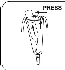
Posicionar uma ampola Vacu-vial® no recipiente de recolha da amostra. Partir a ponta da ampola pressionando ligeiramente contra a parede do recipiente. Aguardar o enchimento total da ampola.
