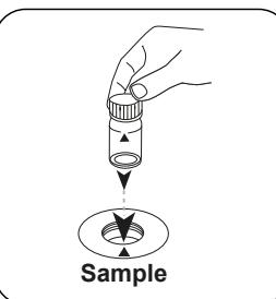
Placez la **cuvette réservée à l'échantillon** dans la chambre de mesure.
