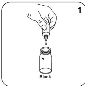
Introdurre **1 goccia di Vario ALUMINIUM ECR Masking Reagent** nella cuvetta zero.
