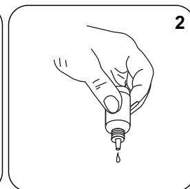
**2 druppels KS135 (Phenolphthalein Substitute Indikator)** toevoegen.
