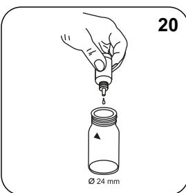
Adicionar **20 gotas KS251 (Chloride Reagenz A)**.
