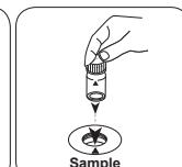
Posizionare la **cuvetta del campione** nel vano di misurazione. Fare attenzione al posizionamento.
