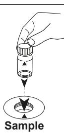
Placez la **cuvette réservée à l'échantillon** dans la chambre de mesure.
