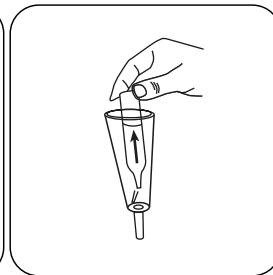
Seguidamente, extraer rápidamente la ampolla llena del recipiente de toma de muestras, con la punta hacia abajo.
