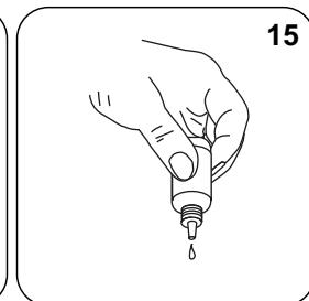
Adicionar **15 gotas** KS278 (50% sulfuric acid).
