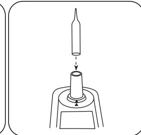
Zero-Ampulle aus dem Messschacht nehmen.
