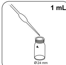
Añadir **1 mL de solución (25 drops) Polyacrylate Precipitant A2** en la cubeta de muestra.
