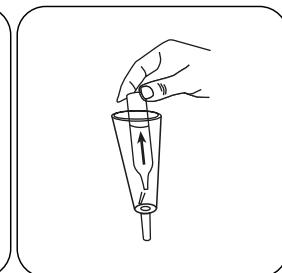
Die volle Ampulle anschließend zügig, mit der Spitze nach unten, aus dem Probenahmegeräß nehmen.
