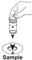
Posizionare la **cuvetta del campione** nel vano di misurazione.
