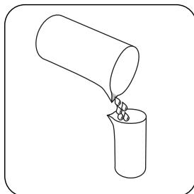
Ein geeignetes Aufschlussgefäß mit **50 mL homogenisierter Probe** füllen.
