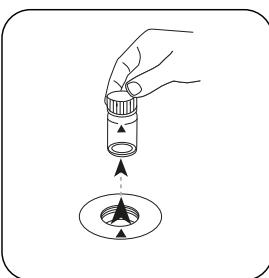
Prelevare la cuvetta dal vano di misurazione.
