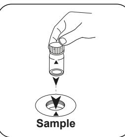
Die Probenküvette in den Messschacht stellen.
