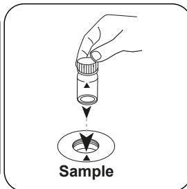
Die Probenküvette in den Messschacht stellen.
