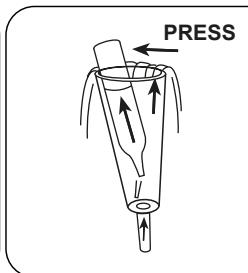
Een Vacu-vial®-ampul in de staalfnamebeker plaatsen. De punt van de ampul afbreken door die licht tegen de wand van de beker te drukken. De volledige vulling van de ampul verwachten.
