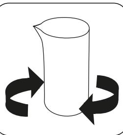
Mettez le tube de fractionnement plusieurs fois à l'envers et laissez-le refroidir à température ambiante.
