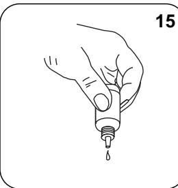
Añadir **15 gotas de KS278 (50% ácido sulfúrico)**.
