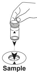
将样本比色杯放入测量轴中。注意定位。
