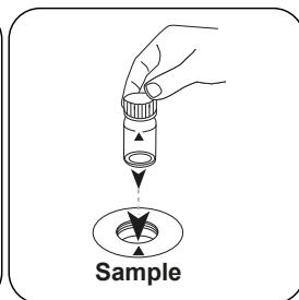
Die Probenküvette in den Messschacht stellen.
