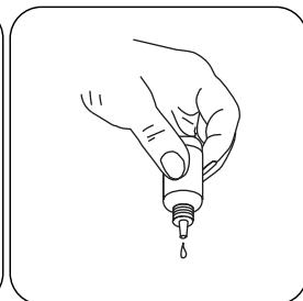
Añadir gota a gota **Hardness Calcium Buffer CH2** en la misma muestra hasta que adquiera una coloración de rosa pálido a roja. (**¡Atención: después de añadir cada gota debe agitarse la muestral!**)
