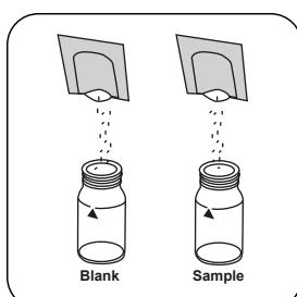
Immettere **una bustina di polvere Vario OXYSCAV 1 Rgt** in ogni cuvetta.
