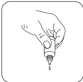
Ajoutez au goutte à goutte **Hardness Calcium Buffer CH2** au même échantillon jusqu'à obtention d'une coloration rosée à rouge.
