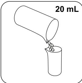
Versez **20 mL d'échantillon** dans un bêcher de mesure de 100 mL.
