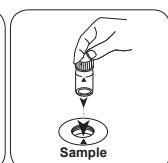
Placez la cuvette réservée à l'échantillon dans la chambre de mesure.
