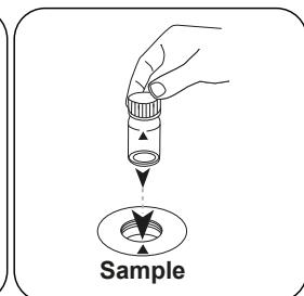
Die **Probenküvette** in den Messschacht stellen.
