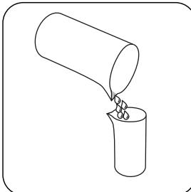
用 50 mL 均质化的样本填充合适的消解容器。
