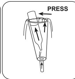
Colocar una ampolla de Vacu-vial® en el recipiente de toma de muestras. Romper la punta de la ampolla presionando ligeramente contra la pared del recipiente. Esperar hasta que se llene completamente la ampolla.
