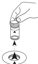
Taste **ZERO** drücken.Küvette aus dem
