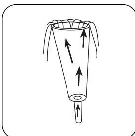
将含测试水的取样容器从底部向上倒置几分钟以去除气泡。
