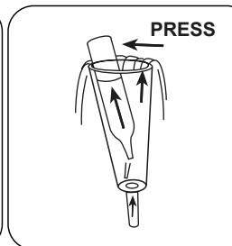
Eine Vacu-vial® Ampulle im Probenahmegeräß platzieren. Die Ampullenspitze durch leichtes Drücken gegen die Gefäßwand abbrechen. Die komplette Füllung der Ampulle abwarten.
