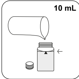
用 10 mL 去离子水填充 24 mm 比色杯。
