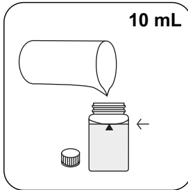
24-mm-Küvette mit 10 mL Probe füllen.
