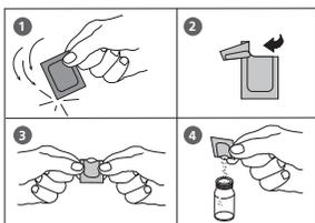
5. In die 5-ml-Probe den Inhalt **zweier Chlorine TOTAL-DPD/ F10 Pulverpäckchens** direkt aus der Folie zugeben.
