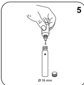
Add **5 drops Reagent Pb-1K solution** to each vial.
