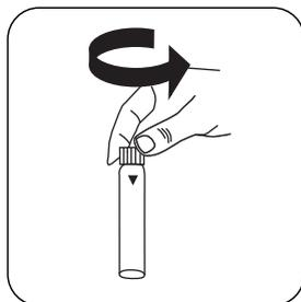
Open a digestion vial  $\text{PO}_4\text{-P}$  Acid Reagent.
