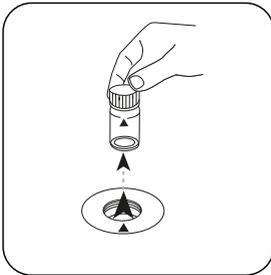
Prelevare la cuvetta dal vano di misurazione.
