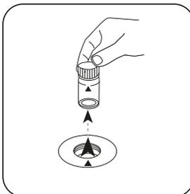
Prelevare la cuvetta dal vano di misurazione.
