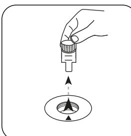
Prelevare la **cuvetta** dal vano di misurazione.
