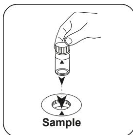
Die Probenküvette in den Messschacht stellen.
