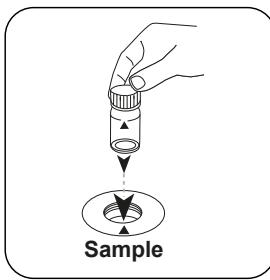
Die Probenküvette in den Messschacht stellen.
