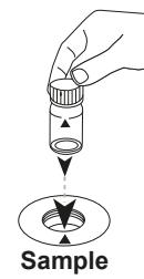
Die Probenküvette in den Messschacht stellen.
