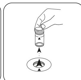
Prelevare la cuvetta dal vano di misurazione.
