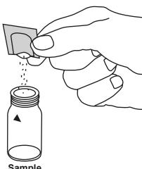
Der Probenküvette ein **Vario Silica Amino Acid F10 Pulverpäckchen** zugeben.
