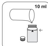
24 mm'lik küveti 10 ml numune ile doldurun.
