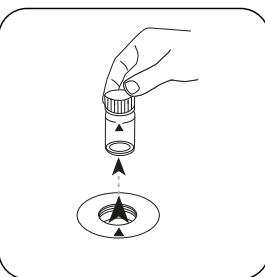
Prelevare la cuvetta dal vano di misurazione.
