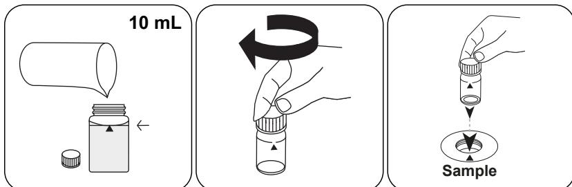
24-mm-Küvette mit **10 mL Probe** füllen.
