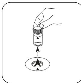
Prelevare la cuvetta dal vano di misurazione.
