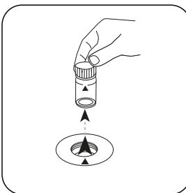
Prelevare la cuvetta dal vano di misurazione.
