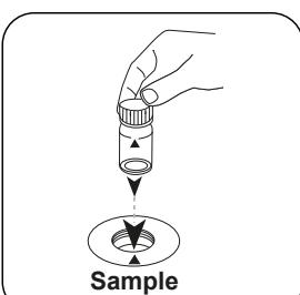
Die Probenküvette in den Messschacht stellen.
