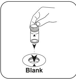
Posizionare la cuvetta zero nel vano di misurazione.
