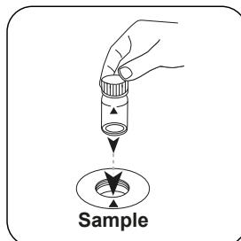
Die Probenküvette in den Messschacht stellen.
