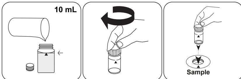
24 mm'lik küveti **10 mL** numune ile doldurun.
