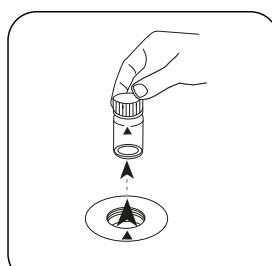
Küvette aus dem Messschacht nehmen.
