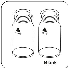
Preparare due cuvette pulite da 24 mm.
