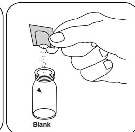
Adicionar à célula zero um **pacote de pó CU3 Masking F10**.
