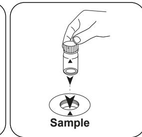
Die **Probenküvette** in den Messschacht stellen.
