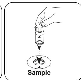
Die Probenküvette in den Messschacht stellen.
