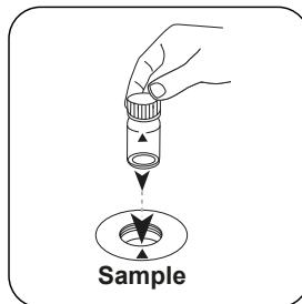
Die Probenküvette in den Messschacht stellen.
