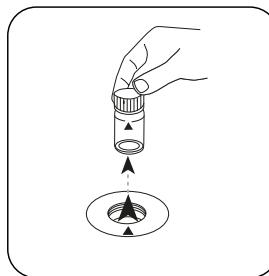
Prelevare la cuvetta dal vano di misurazione.
