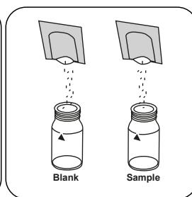
Immettere **una bustina di polvere CU2 Porphyrin F10** in ogni cuvetta.
