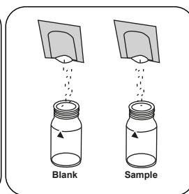
Immettere **una bustina di polvere CU1 Porphyrin F10** in ogni cuvetta.
