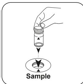
Die **Probenküvette** in den Messschacht stellen.
