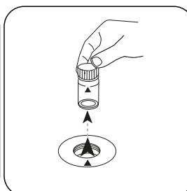
Prelevare la cuvetta dal vano di misurazione.
