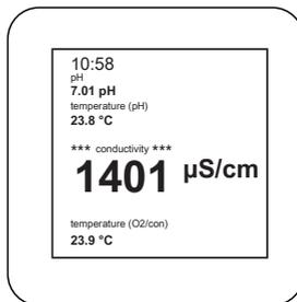
Il valore misurato ora può essere letto sul display. Nella configurazione dei parametri è possibile commutare la conduttività all'occorrenza su TDS o Salinità.
