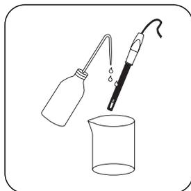
Risciacquare l'elettrodo prima con acqua distillata o deionizzata, poi con il campione.
