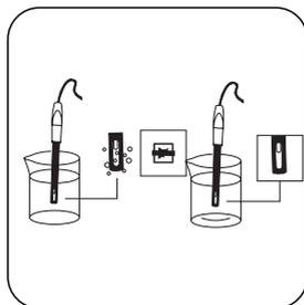
Immergere la cella di misurazione nel campione. Durante la misurazione, assicurarsi che non vi siano bolle d'aria sulla superficie dell'elettrodo e che l'elettrodo e la sonda termica siano sufficientemente circondati dalla soluzione di riferimento.
