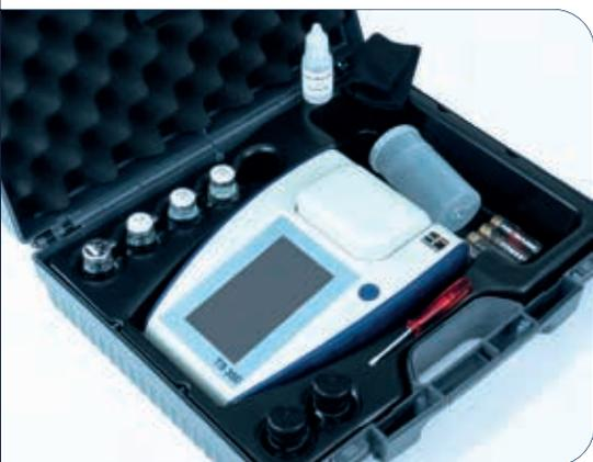
Llévatelo o déjalo: El turbidímetro TB350 es ideal para su uso móvil in situ, por ejemplo, para controlar los sistemas de suministro de agua y para los laboratorios que analizan una amplia gama de muestras.
