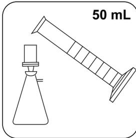
Filtrar unos 50 mL de muestra con un filtro prelavado (porosidad 0,45  $\mu\text{m}$ ).
