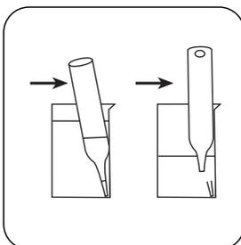
Colocar una ampolla de Vacu-vial® en el recipiente de muestra. Romper la punta de la ampolla presionando ligeramente contra la pared del recipiente. Esperar hasta que se llene completamente la ampolla.
