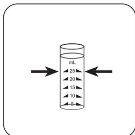
Llenar el vaso de muestra con la muestra hasta la marca de 25 mL.
