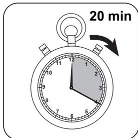
Hervir la muestra durante **20 minutos**. Debe mantenerse un volumen de muestra de 25 mL, si conviene rellenar con agua desionizada.
