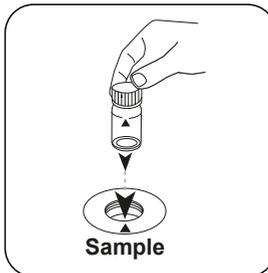
Poner la **cubeta de muestra** en el compartimento de medición. ¡Debe tenerse en cuenta el posicionamiento!
