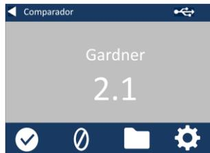
8 - Pulse el botón de resultado en la pantalla para alternar entre el modo numérico y el modo comparador.
