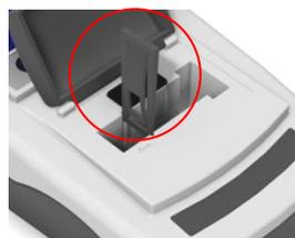
4 - Cierre la tapa de la muestra y pulse la tecla de cero en el teclado o en la pantalla.
