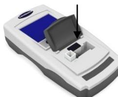
4 - Cierre la tapa de la muestra y pulse la tecla de ensayo en el teclado o en la pantalla.
