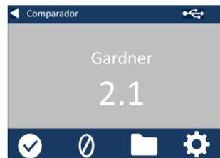
9 - Pulse la flecha atrás en la pantalla para alternar entre el modo numérico y el modo comparador.
