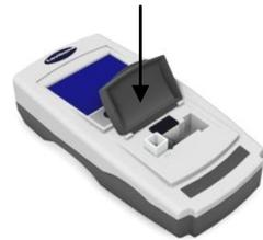
8 - Cierre la tapa de la muestra y pulse la tecla de ensayo en el teclado o en la pantalla.
