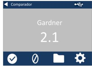
11 - Compare el resultado del instrumento con el valor que aparece en la etiqueta del líquido de validación para saber si está dentro de las tolerancias especificadas.
