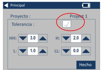
9 – Para modificar los valores de tolerancia, utilice las teclas de flecha arriba y abajo. Seleccione Hecho cuando haya terminado.
