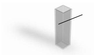
3 - Coloque la celda en la cámara de muestras del EC 2000 Gardner, a la izquierda del divisor de celdas.
