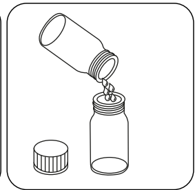
Die vorbereitete Glyciniösung in die vorbereitete Küvette füllen.
