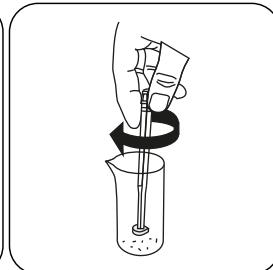
Agitar a(s) pastilha(s) para dissolver com uma varetta agitadora limpa.
