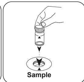
Die **Probenküvette** in den Messschacht stellen.
