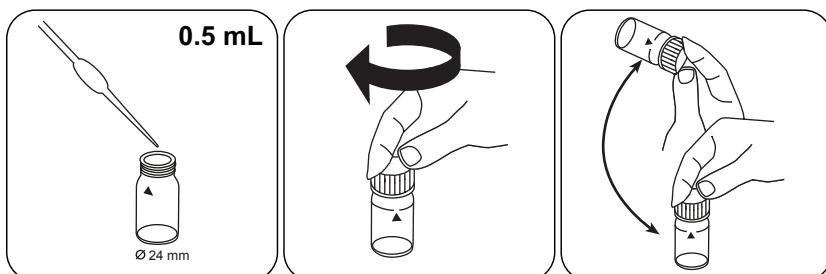
Adicionar **0.5 mL Molybdenum 2 LR de solução** à célula de amostra.
