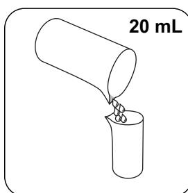
Añadir **20 mL de muestra** en un vaso de medición de 100 mL.
