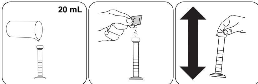
Añadir **20 mL de muestra** en un cilindro de mezcla de 25 mL.
