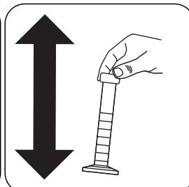
Mischzylinder mit einem Stopfen verschließen. Pulver durch Schütteln lösen.
