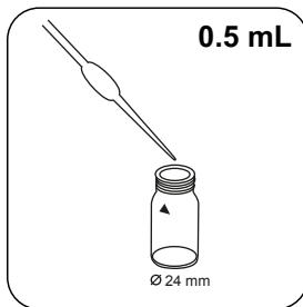
**0.5 mL Molybdenum 2 LR Lösung** in die Probenküvette geben.
