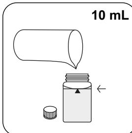
24-mm-Küvette mit **10 mL** Küvette(n) verschließen.
