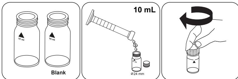
Preparar duas células de 24 mm limpas. Identificar uma célula como célula zero.
