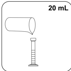
Immettere **20 mL di campione** in un cilindro di miscelazione da 25 mL.
