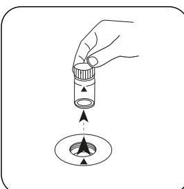
Prelevare la cuvetta dal vano di misurazione.
