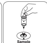
Colocar a célula de amostra no compartimento de medição. Observar o posicionamento.
