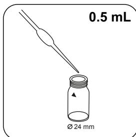
Introdurre **0.5 mL di soluzione Molybdenum 2 LR** nella cuvetta del campione.
