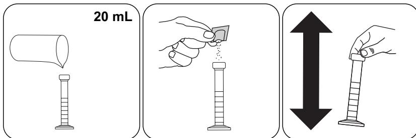
Introduzir **20 mL de amostra** num cilindro misturador de 25 mL.
