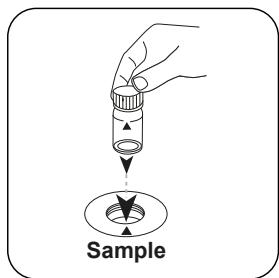
Die Probenküvette in den Messschacht stellen.
