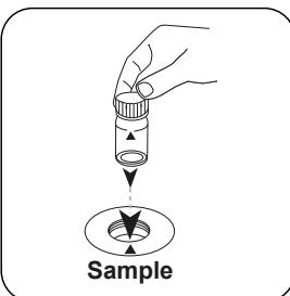
Die Probenküvette in den Messschacht stellen.
