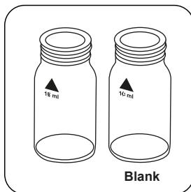
Préparez deux cuvettes propres de 24 mm. L'une des deux cuvettes sera la cuvette du blanc. Étiquetez-la.
