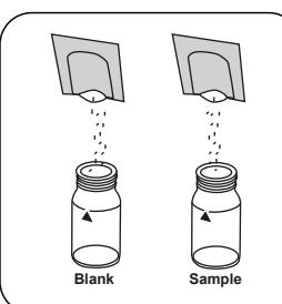
Immettere una bustina di polvere Vario Silica Citric Acid F10 in ogni cuvetta.
