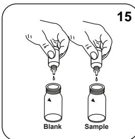
Dans chaque cuvette, versez **15 gouttes de solution Vario Molybdate 3 Reagenz-**.
