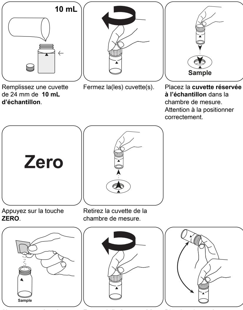
Remplissez une cuvette de 24 mm de **10 mL** d'échantillon.
