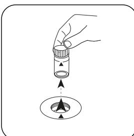
Prelevare la cuvetta dal vano di misurazione.
