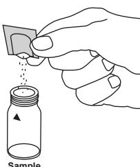
Der Probenküvette ein **Vario Silica Amino Acid F10 Pulverpäckchen** zugeben.
