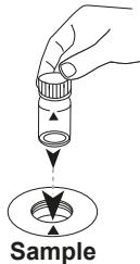
Colocar a **célula de amostra** no compartimento de medição. Observar o posicionamento.
