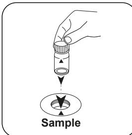
Die **Probenküvette** in den Messschacht stellen.
