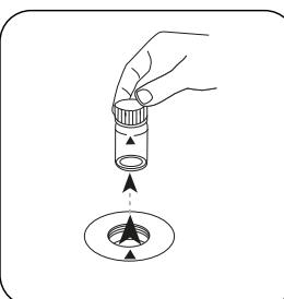
Prelevare la cuvetta dal vano di misurazione.
