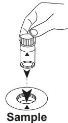
Placez la **cuvette réservée à l'échantillon** dans la chambre de mesure.
