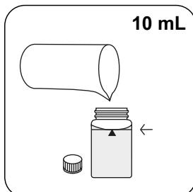
24-mm-Küvette mit **10 mL** Küvette(n) verschließen.
