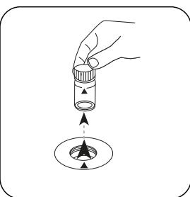
Prelevare la cuvetta dal vano di misurazione.
