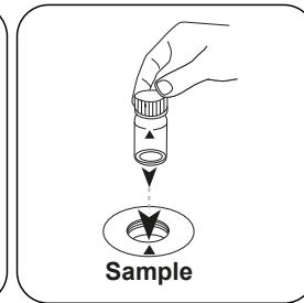
Die Probenküvette in den Messschacht stellen.
