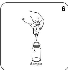
Introdurre **6 gocce di PHENOL Red-Lösung** nella cuvetta del campione.
