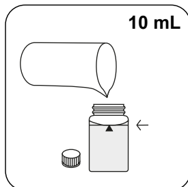
用 10 mL 去离子水填充 24 mm 比色杯。
