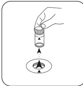
Prelevare la cuvetta dal vano di misurazione.
