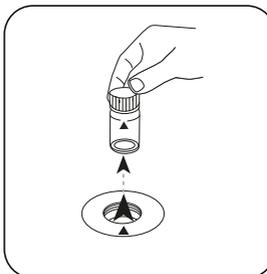
Prelevare la cuvetta dal vano di misurazione.
