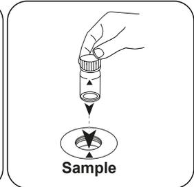
Posizionare la **cuvetta del campione** nel vano di misurazione. Fare attenzione al posizionamento.
