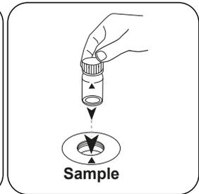
Poner la **cubeta de muestra** en el compartimento de medición. ¡Debe tenerse en cuenta el posicionamiento!
