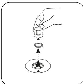
Prelevare la cuvetta dal vano di misurazione.
