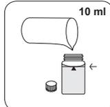
24-mm-Küvette mit **10 ml Probe** füllen.
