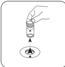
Prelevare la cuvetta dal vano di misurazione.
