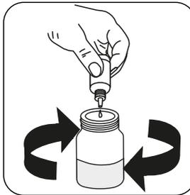
**Alkalinity LR Titrierlösung TA3 oder Alkalinity HR Titrierlösung PA2/TA2** tropfenweise der Probe zugeben bis die Verfärbung von **rosa** nach **farblos** umschlägt.
