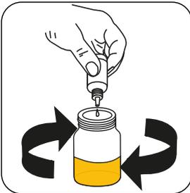
**Alkalität LR Titrierlösung TA3 oder Alkalinity HR Titrierlösung PA2/TA2** tropfenweise der Probe zugeben bis die Färbung von **blau** bis **orange/gelb** umschlägt.
