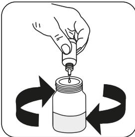
**Alkalität LR Titrierlösung TA3 oder Alkalität HR Titrierlösung PA2/TA2** tropfenweise der Probe zugeben bis die Verfärbung von **pink** nach **farblos** umschlägt.
