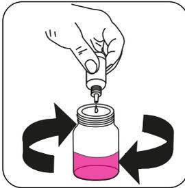
Tropfen **Säure / Alkalität P Indikator PA1** hinzufügen, bis eine **rosa** Färbung entsteht. Hinweis: Bleibt die Probe farblos, ist die P-Alkalinität mit Null anzugeben.
