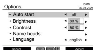
可以在 "选项" 子菜单中改变仪器设置。使用向上▲和向下▼方向键选择一个设置。使用左◀和右►方向键改变所选设置。使用功能键 F2 接受新的设置，或使用功能键 F1 返回主菜单。
