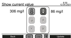
Последние измерения можно отслеживать в подменю "Показать текущее значение". Все шесть положений бутылок отображаются в центре экрана. Последнее значение отображается рядом с головкой датчика, если он подключен к системе.
