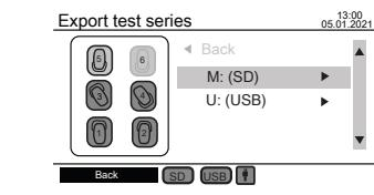
屏幕左边显示 6 个传感器头测量位置示意图。
