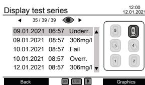
**Underrange** 如果记录的测量值低于起始测量值，则显示“欠量程”，而不是测量值。
