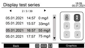
所有传感器头位置的示意图显示在屏幕的右边部位。
