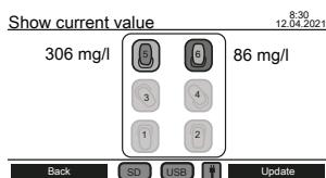
在子菜单 "显示当前值" 中可以跟踪最新的测量结果。所有六个瓶子的位置都显示在屏幕的中央。如果连接到系统中，最新的数值会显示在传感器头的旁边。
