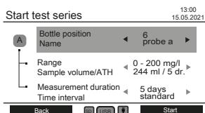
После подготовки образца войдите в подменю "Начать серию испытаний", чтобы начать измерение.
