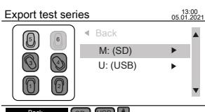
На левой части экрана отображается схема всех положений бутылок. Используйте кнопки головок для выбора и отмены выбора головок датчиков для экспорта данных. Только выбранные головки рассматриваются для экспорта данных. Используйте клавиши со стрелками вверх ▲ и вниз ▼ для выбора между SD-картой и USB-накопителем, если оба подключены. Для продолжения
