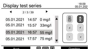
На правой части экрана отображается схема всех положений бутылок. Для выбора положения бутыли можно использовать кнопки головки. После этого данные измерений выбранной головки перечисляются в мг/л с отметкой времени.
