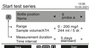
样品制备完成后，进入子菜单 "开始测试系列"，开始进行测量。
