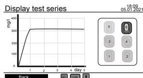
Используйте клавиши головки для выбора и отмены выбора головки датчика для построения графика измеренных данных. Для сравнения можно одновременно отображать максимум три графика.
