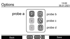
Введите настройку "Name heads" в разделе "Options", чтобы дать головкам датчика имя. Все шесть положений бутылек отображаются в центре экрана. Для выбора позиции бутылки можно использовать кнопки головок. Выбор бутылки можно отследить по красному светодиоду на верхней части головки датчика. Для ввода имени выбранной головки датчика используйте цифровые клавиши, клавишу Backspace и клавиши со стрелками влево ▲ и вправо ▼.
