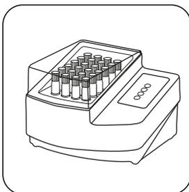
在预热的热反应器中，在 100°C 下密封比色杯 120 分钟。
