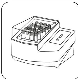
Sottoporre a digestione la/e cuvetta/e nel termoreattore preriscaldato per **120 minuti a 150 °C**.
