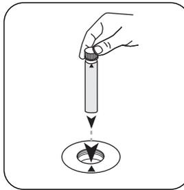
Posizionare la **cuvetta zero** nel vano di misurazione. Fare attenzione al posizionamento.
