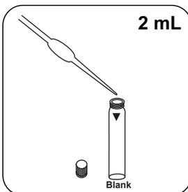
Immettere **2 mL di acqua demineralizzata** nella cuvetta zero.
