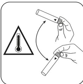
Miscelare il contenuto capovolgendo con cautela. **Attenzione: sviluppo di calore!**
