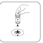
Prelevare la cuvetta dal vano di misurazione.
