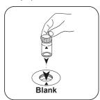
Posizionare la cuvetta zero nel vano di misurazione. Fare attenzione al posizionamento.
