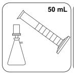
Filtrare circa 50 mL di campione con un filtro precedentemente risciacquato (diametro pori 0,45 µm).
