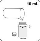
Immettere 10 mL di acqua Chiudere la/e cuvetta/e. demineralizzata nella cuvetta zero.
