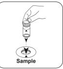
Posizionare la **cuvetta del campione** nel vano di misurazione. Fare attenzione al posizionamento.
