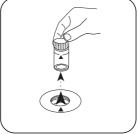
Prelevare la cuvetta dal vano di misurazione.
