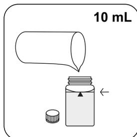
Наполните кювету 24 мм полностью деминерализованной воды 10.
