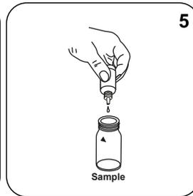
Añadir **5 gotas de Free Chlorine Reagent Solution** en la cubeta con la muestra.
