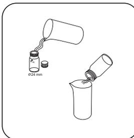
Pré-enxaguar a célula com a amostra de água.
