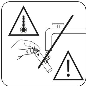
Deixar a célula invertida arrefecer durante 1 hora. **Não arrefecer com água!** Depois de arrefecer, gire e no espaço de 10 min medir no fotómetro.
