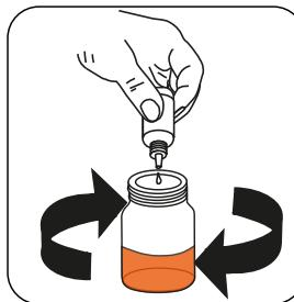
Add **Chloride LR Titrant CC2 or Chloride HR**
