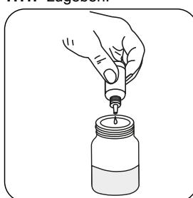
Tropfenweise Hardness LR Titrant TH3 oder Hardness HR Titrant TH4 hinzufügen, bis eine **rein blaue** Färbung entsteht.
