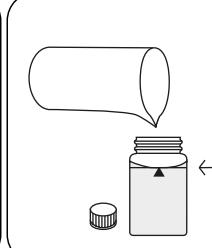
Küvette bis zur **10-mL-Marke** mit der **Probe** auffüllen.
