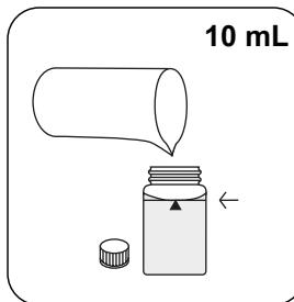
24-mm-Küvette mit **10 mL Probe** füllen.
