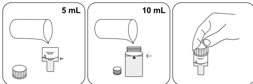
10 mm'lik küveti **5 mL numune** ile doldurun.
