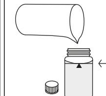
MD50: 24 mm'lik küveti **10 mL numune** ile doldurun.
