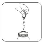
Achtung! Notieren Sie die Anzahl der Tropfen die hinzugefügt werden. Hinweis: Nach Zugabe jedes Tropfens das Probengefäß schwenken!
