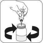
Alkalinity Reagenz ALK3 oder Alkalinity Reagenz ALK4 tropfenweise der Probe zugeben bis die Verfärbung von rosa nach farblos umschlägt.
