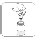
Bei Verwendung von chlorhaltigen Produkten 5 Tropfen Alkalinity Dechloration Reagenz CL3 pro 20 mL Probe zugeben.
