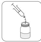
Achtung!Das passende Probenvolumen entsprechend der Anweisungen im Kapitel Probenahme auswählen.
