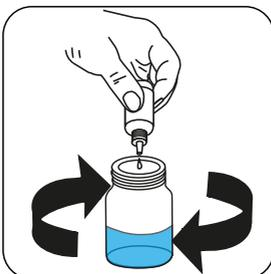
**Härte LR Titrierlösung TH3 oder Härte HR Titrierlösung TH4** tropfenweise der Probe zugeben bis die Färbung von **weinrot** bis **blau** umschlägt.
