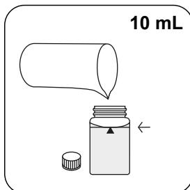
24-mm-Küvette mit **10 mL** Küvette(n) verschließen.
