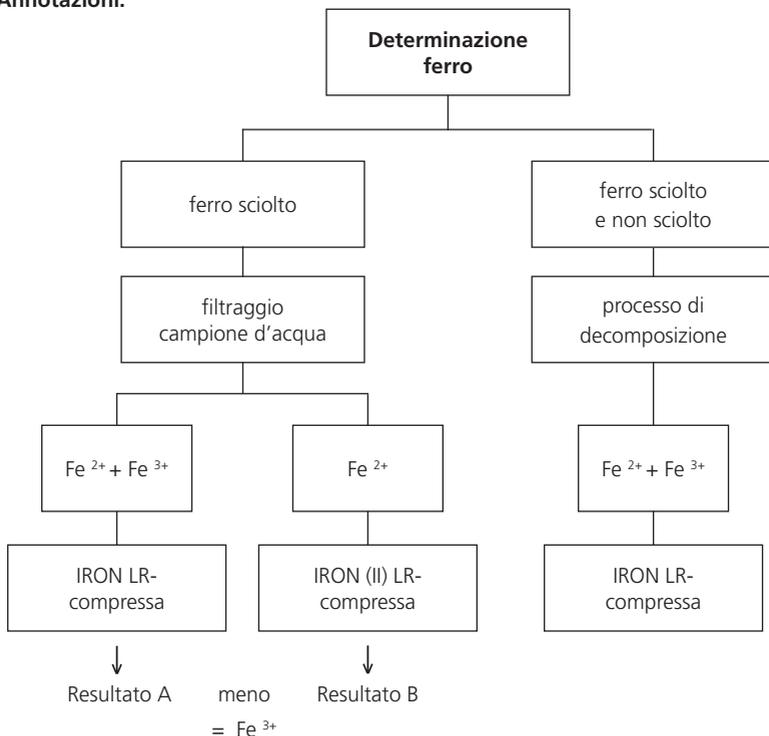
**Processo di decomposizione** per la determinazione del ferro complessivamente sciolto e non sciolto:
