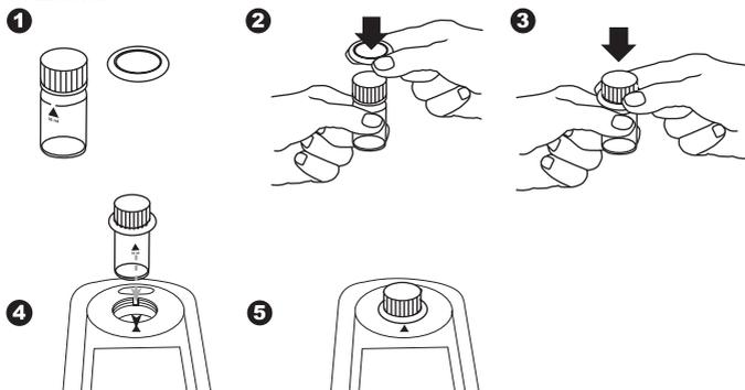
6. La formazione di bollicine nelle parete interne della cuvetta può condurre a misurazioni errate. In tal caso la cuvetta viene chiusa con l'apposito coperchio e le bollicine vanno sciolte agitando la cuvetta stessa prima dell'esecuzione del test.
