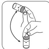
Tablette(n) durch Umschwenken lösen.
