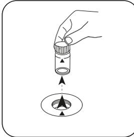
Prelevare la cuvetta dal vano di misurazione.
