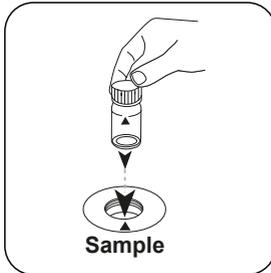
Posizionare la **cuvetta del campione** nel vano di misurazione. Fare attenzione al posizionamento. Sul display compare il risultato in mg/l di Cloro libero.
