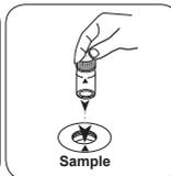
Die **Probenküvette** in den Messschacht stellen. Positionierung beachten.
