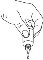
Tenere le boccette contagocce in posizione verticale e introdurre, premendo lentamente, gocce della stessa dimensione nella cuvetta.
