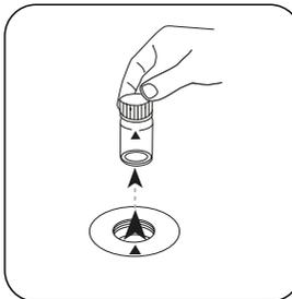
Prelevare la cuvetta dal vano di misurazione.
