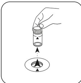
Prelevare la cuvetta dal vano di misurazione.
