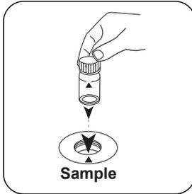
Die **Probeküvette** in den Messschacht stellen. Positionierung beachten. In der Anzeige erscheint das Ergebnis in mg/l freies Chlor.
