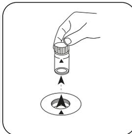
Prelevare la cuvetta dal vano di misurazione.
