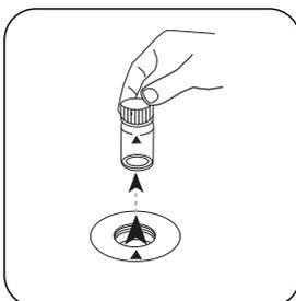
Prelevare la cuvetta dal vano di misurazione.
