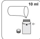
Remplissez une cuvette de 24 mm de **10 ml d'échantillon**.
