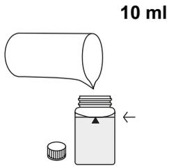
24-mm-Küvette mit **10 ml Probe** füllen.
