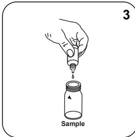
Introdurre **3 gocce di DPD 3 Solution** nella cuvetta del campione.
