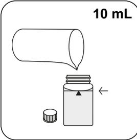
24 mm'lik küveti **10 mL numune** ile doldurun.
