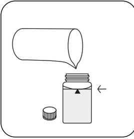
Küveti **10 mL işaretine** kadar **numune** ile doldurun.
