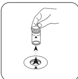
Prelevare la cuvetta dal vano di misurazione.
