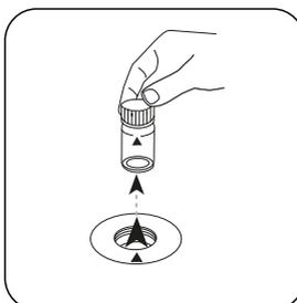
Prelevare la cuvetta dal vano di misurazione.
