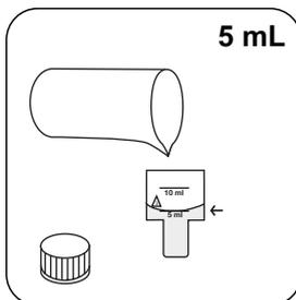
Remplissez une cuvette de 10 mm de **5 mL** d'échantillon.
