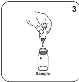
Introdurre **3 gocce di DPD 3 Solution** nella cuvetta del campione.
