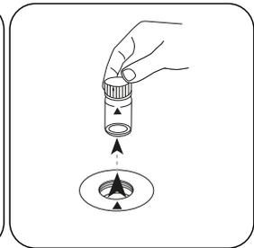
Prelevare la cuvetta dal vano di misurazione.
