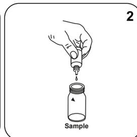
**2 Tropfen DPD 1 Reagenz-Lösung** in die **Probeküvette** geben.
