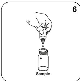
Introdurre **6 gocce di DPD 1 Buffer Solution** nella cuvetta del campione.
