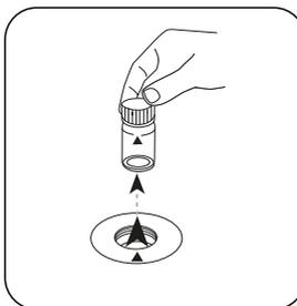
Prelevare la cuvetta dal vano di misurazione.
