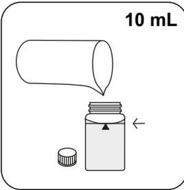
24 mm'lik küveti **10 mL numune** ile doldurun.
