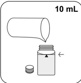
24-mm-Küvette mit **10 mL Probe** füllen.
