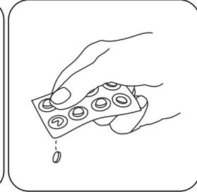
**DPD No 1 ve No. 3 tablet alternatif olarak, 1 DPD No 4 tablet eklenebilir.**
