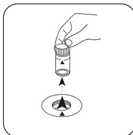
Prelevare la cuvetta dal vano di misurazione.
