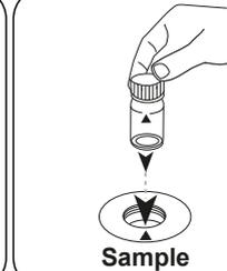
将样本比色杯放入测量轴中。注意定位。
