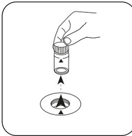
Prelevare la cuvetta dal vano di misurazione.
