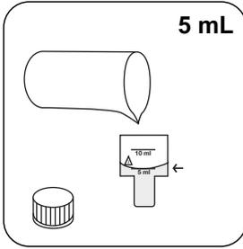
10 mm'lik küveti **5 mL numune** ile doldurun.
