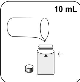
24-mm-Küvette mit **10 mL Probe** füllen.
