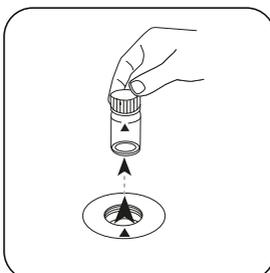
Prelevare la cuvetta dal vano di misurazione.
