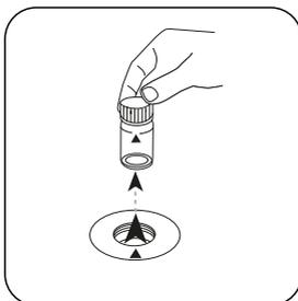
Prelevare la cuvetta dal vano di misurazione.
