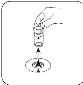
Prelevare la cuvetta dal vano di misurazione.
