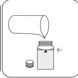
Küveti **10 mL işaretine** kadar **numune** ile doldurun.
