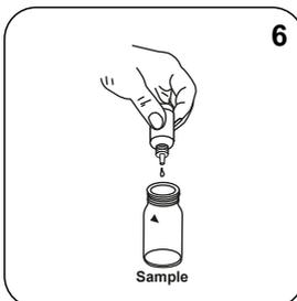
**6 Tropfen DPD 1 Puffer-Lösung** in die **Probeküvette** geben.
