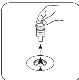
Prelevare la **cuvetta** dal vano di misurazione.
