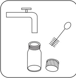
Die Küvette und den Küvettendeckel gründlich reinigen.
