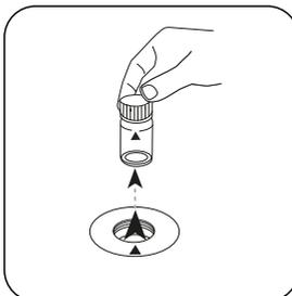
Prelevare la cuvetta dal vano di misurazione.
