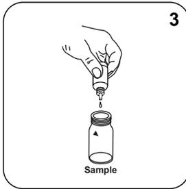
Adicionar **3 gotas DPD 3 Solution** à célula de amostra.
