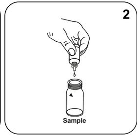
Introdurre **2 gocce di DPD 1 Reagent Solution** nella cuvetta del campione.
