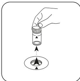
Prelevare la cuvetta dal vano di misurazione.
