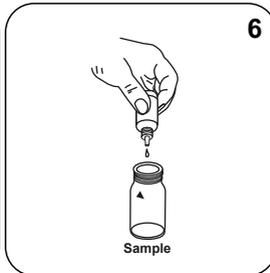
Adicionar **6 gotas DPD 1 Buffer Solution** à célula de amostra.
