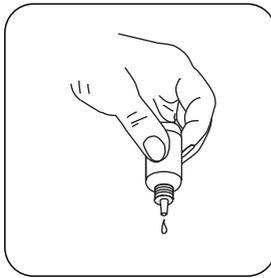
Tenere le boccette contagocce in posizione verticale e introdurre, premendo lentamente, gocce della stessa dimensione nella cuvetta.
