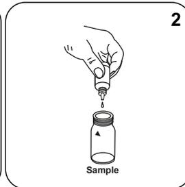
Adicionar **2 gotas DPD 1 Reagent Solution** à célula de amostra.
