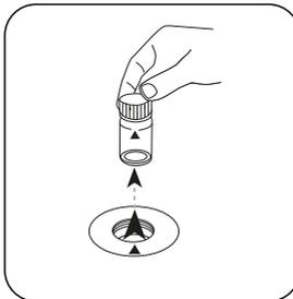
Prelevare la cuvetta dal vano di misurazione.
