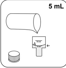
10 mm'lik küveti **5 mL numune** ile doldurun.
