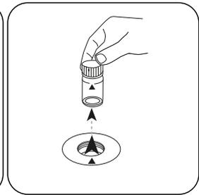
Küvette aus dem Messschacht nehmen.
