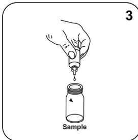
Ajoutez **3 gouttes de DPD 3 Solution** dans la cuvette réservée à l'échantillon.
