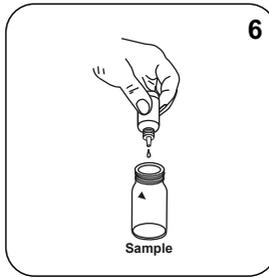
Introdurre **6 gocce di DPD 1 Buffer Solution** nella cuvetta del campione.
