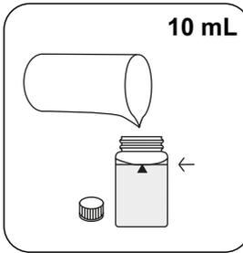
24-mm-Küvette mit **10 mL Probe** füllen.
