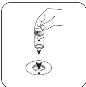
Colocar a **célula** Cloraminiano compartimento de medição. Observar o posicionamento.
