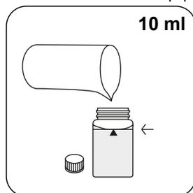
Encher a célula de Fluoresceína mm com **10 ml de amostra**.
