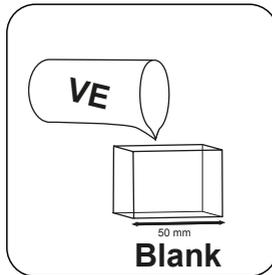
Encher a **célula de 50 mm** com **água desmineralizada**.
