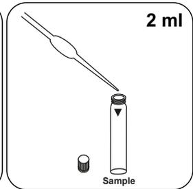
Adicionar **2 ml de amostra** à célula de amostra.
