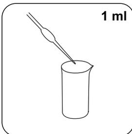
Adicionar **1 ml ácido sulfúrico concentrado** .
