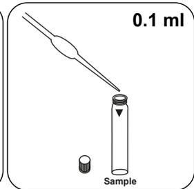
Adicionar **0.1 ml de amostra** à célula de amostra.
