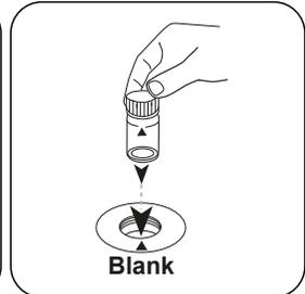
Colocar a **célula zero** no compartimento de medição. Observar o posicionamento.
