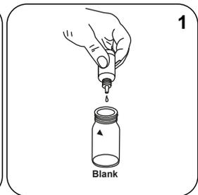
Adicionar **1 gotas Vario ALUMINIUM ECR Masking Reagent** à célula zero.
