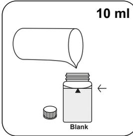
Adicionar **10 ml de água desmineralizada** à célula zero.
