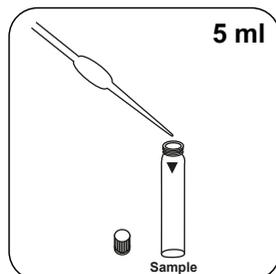
Adicionar **5 ml de amostra** à célula de amostra.
