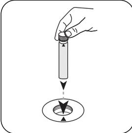
Colocar a célula zero fornecida (autocolante vermelho) no compartimento de medição. Observar o posicionamento.
