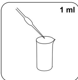
Adicionar **1 ml ácido sulfúrico concentrado**.
