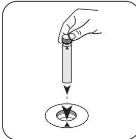
Colocar a **c3lula de amostra** no compartimento de medi33o. Observar o posicionamento.
