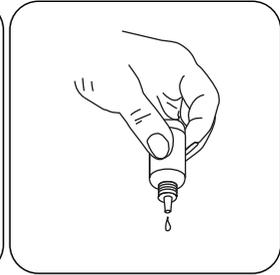
Adicionar **KS 144 (Calcium Hardness Puffer)** gota a gota da mesma amostra até aparecer uma coloração ligeiramente rosa a avermelhada. **(Atenção: assim que adicionar cada gota, agite a amostra!)**
