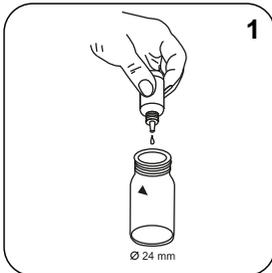
Adicionar **1 gotas Free Ammonia Reagent Solution** à célula de amostra.
