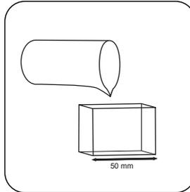
Encher a **célula de 50 mm** com **amostra**.
