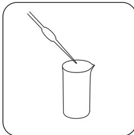
Introduzir no recipiente de amostra **2 ml de amostra e 8 ml de água desmineralizada**.
