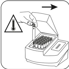
Retirar a célula do reator térmico. **(Atenção: A célula está quente!)**
