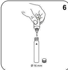
Adicionar **6 gotas H<sub>2</sub>O<sub>2</sub>-Reagent Solution**.
