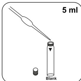
Adicionar **5 ml de água desmineralizada** à célula zero.
