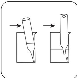
Posicionar uma ampola Vacu-vial® no recipiente de amostra. Partir a ponta da ampola pressionando ligeiramente contra a parede do recipiente. Aguardar o enchimento total da ampola.
