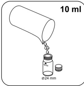
Encher uma **segunda célula** com **10 ml de amostra** .
