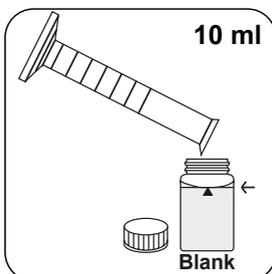
Adicionar **10 ml de amostra preparada** à célula zero.
