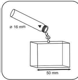
Encher a célula de 50 mm com a amostra preparada.
