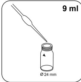
Encher a célula de 24 mm com **9 ml de água desmineralizada**.
