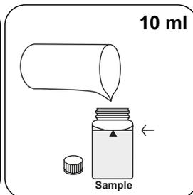
Adicionar **10 ml de amostra** à célula de amostra.
