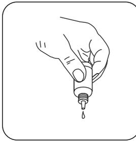
Adicionar **KS 144 (Calcium Hardness Puffer)** gota a gota da mesma amostra até aparecer uma coloração ligeiramente rosa a avermelhada. **(Atenção: assim que adicionar cada gota, agite a amostra!)**
