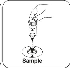
Colocar a **célula de amostra** no compartimento de medição. Observar o posicionamento.
