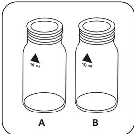
Preparar duas células de Cloramina mm limpas. Identificar uma célula como célula zero.
