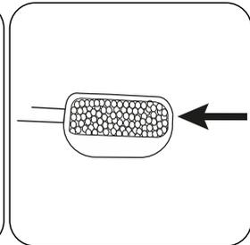
Adicionar **uma colher medida com traços No. 8 (preto) Digestion Reagent**.
