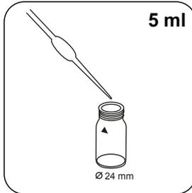
Encher a célula de 24 mm com **5 ml de água desmineralizada**.
