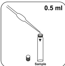
Adicionar **0.5 ml de amostra** à célula de amostra.
