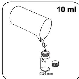
Encher a célula de 24 mm com **10 ml de amostra preparada**.
