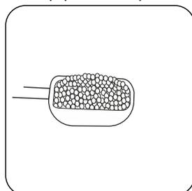
Adicionar **1 g HYDRAZIN Test de pó**.
