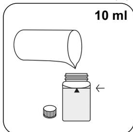
Adicionar **10 ml Nitrite VHR L de solução** à célula de amostra.
