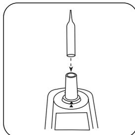
Retirar a ampola zero do compartimento de medição.
