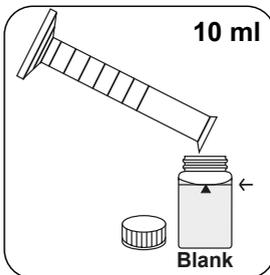
Adicionar **10 ml de amostra preparada não digerida** à célula zero.
