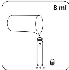
Encher a célula de 16 mm com **8 ml de amostra**.
