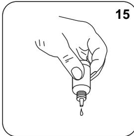
Adicionar **15 gotas KS278 (50% ácido sulfúrico)**.
