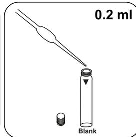
Adicionar **0.2 ml de água desmineralizada** à célula zero.
