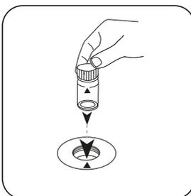
Colocar a **célula** Cloraminano compartimento de medição. Observar o posicionamento.
