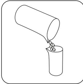
Encher um recipiente de digestão adequado com **50 ml de amostra homogeneizada**.
