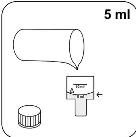
Encher a célula de 10 ml com **5 ml de amostra**.
