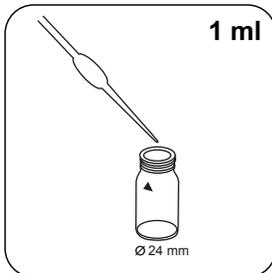
Adicionar **1 ml (25 Tropfen) KS255 (Polyacrylate Reagenz 1)** de solução à célula de amostra.
