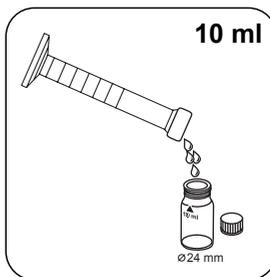
Adicionar **10 ml de amostra** à célula de amostra.
