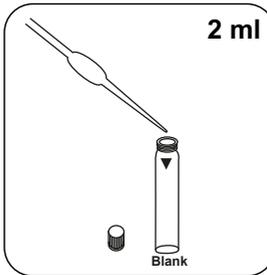
Adicionar **2 ml de água desmineralizada** à célula zero.
