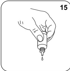
Adicionar **15 gotas KS278 (50% ácido sulfúrico)**.
