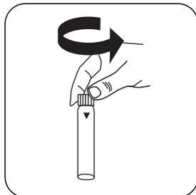
Abrir uma célula de digestão  $\text{PO}_4\text{-P Acid Reagent}$  .
