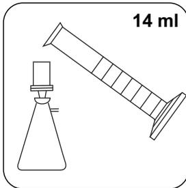
Filtrar cerca de 14 ml de amostra com um filtro pré-enxaguado (dimensão dos poros 0,45  $\mu$ m).
