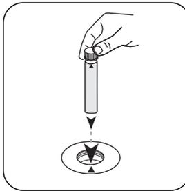
Colocar a **c3lula zero** no compartimento de medi33o. Observar o posicionamento.
