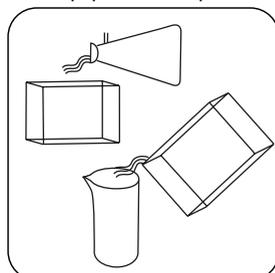
Pré-enxaguar a célula com a amostra de água.
