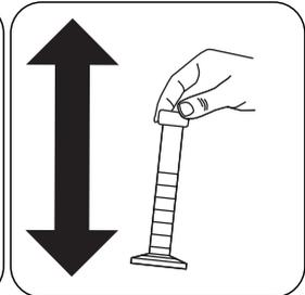
Fechar o cilindro misturador com um tampão. Dissolver o pó agitando.
