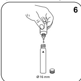
Adicionar **6 gotas H<sub>2</sub>O<sub>2</sub>-Reagent Solution**.
