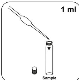
Adicionar **1 ml de amostra** à célula de amostra.
