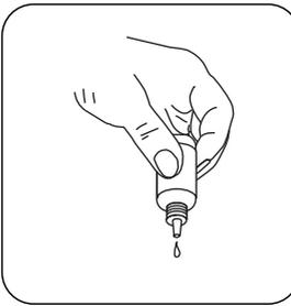
Mantener os frascos conta gotas na vertical e pressionar lentamente para adicionar gotas de igual dimensão.
