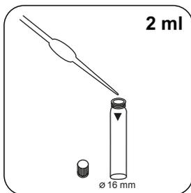
Adicionar **2 ml 1,00 N Sodium Hydroxide solution** da amostra digerida.
