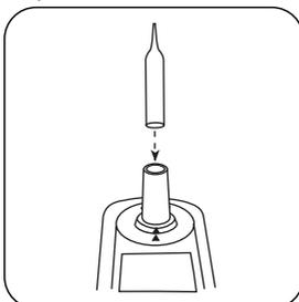
Colocar a ampola no compartimento de medição.
