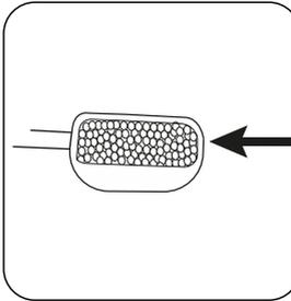
Adicionar **uma colher medida com traços No. 8 (preto) Digestion Reagent**.
