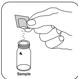
Adicionar um **pacote de pó Vario Silica HR Acid Rgt. F10** .
