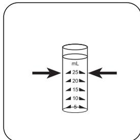
Encher o frasco da amostra até à marca de 25 ml com a amostra.
