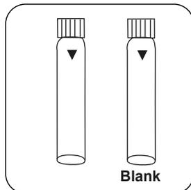
Preparar duas **células de digestão TN Hydroxide LR**. Identificar uma célula como célula zero.
