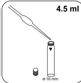
Adicionar **4.5 ml de água desmineralizada** à célula de digestão.
