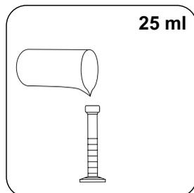
Introduzir **25 ml de amostra preparada** num cilindro misturador de 25 ml.
