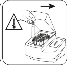
Retirar a célula do reator térmico. **(Atenção: A célula está quente!)**
