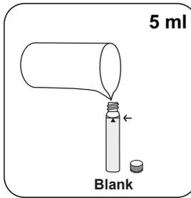
Adicionar **5 ml de água desmineralizada** à célula zero.
