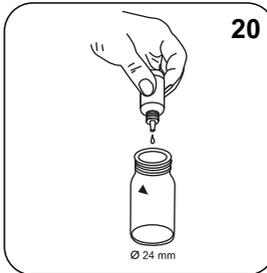
Adicionar **20 gotas KS251 (Chloride Reagent A)**.
