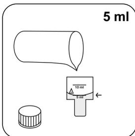
Encher a célula de 10 mm com **5 ml de amostra** .
