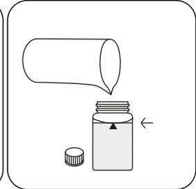
Encher a célula até à **marca de 10 ml** com a amostra.
