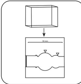
Colocar a **célula zero** no compartimento de medição. Observar o posicionamento.
