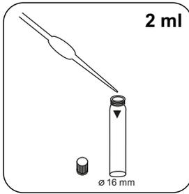
Adicionar **2 ml 1,54 N** solução de hidróxido de sódio da amostra digerida.
