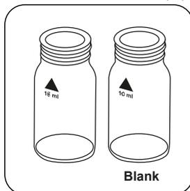
Preparar duas células de 24 mm limpas. Identificar uma célula como célula zero.
