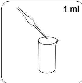
Adicionar **1 ml ácido sulfúrico concentrado** .
