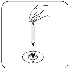
Colocar a célula previamente tratada no compartimento de medição.
