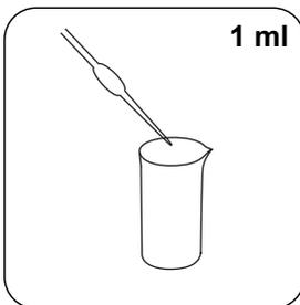
Adicionar **1 ml ácido sulfúrico concentrado**.
