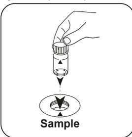
Colocar a **célula de amostra** de medição. Observar o posicionamento.
