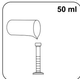
Introduzir **50 ml de amostra** num cilindro misturador de 50 ml.
