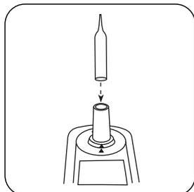
Colocar a **ampola zero** no compartimento de medição.
