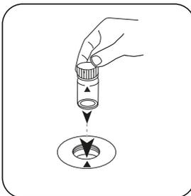
Colocar a **célula** Clorono compartimento de medição. Observar o posicionamento.
