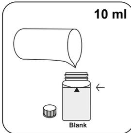
Adicionar **10 ml de água desmineralizada** à célula zero.
