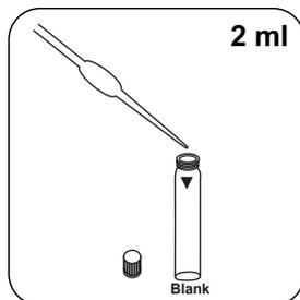
Adicionar **2 ml de água desmineralizada** à célula zero.
