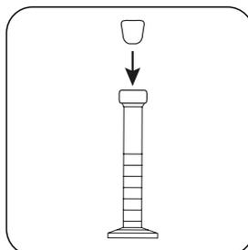
Fechar o cilindro misturador com um tampão. Dissolver o pó girando.
