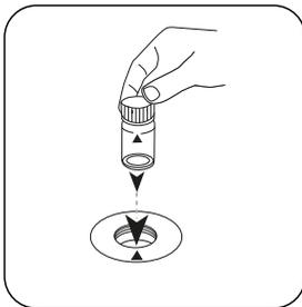
Colocar a **célula** Amoníaco no compartimento de medição. Observar o posicionamento.
