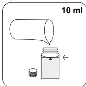
Encher a célula de 24 ml com **10 ml de amostra**.
