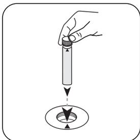
Colocar a célula previamente tratada no compartimento de medição. Observar o posicionamento.
