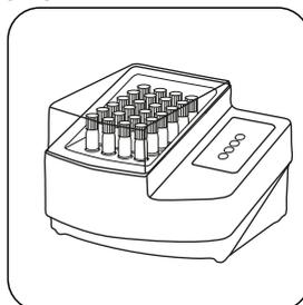
Aquecer a célula durante **120 minutos a 120 °C** no reator térmico pré-aquecido **invertida**.
