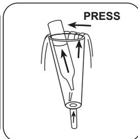
Posicionar uma ampola Vacu-vial® no recipiente de recolha da amostra. Partir a ponta da ampola pressionando ligeiramente contra a parede do recipiente. Aguardar o enchimento total da ampola.
