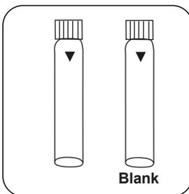
Preparar duas **células TN Acid LR/HR (Reagent C)**. Identificar uma célula como célula zero.
