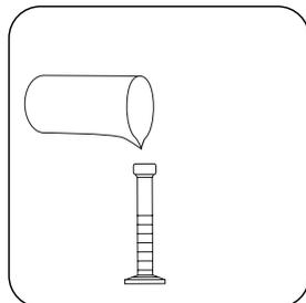
Encher um cilindro de medição de 50 ml com o volume de amostra selecionado. Se necessário, encher com água desmineralizada até 50 ml e misturar.
