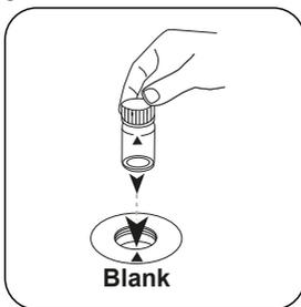
Colocar a **célula zero** no compartimento de medição. Observar o posicionamento.
