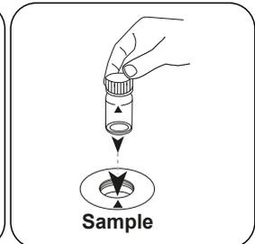
Encher a célula de 24 mm com **10 ml de amostra**.
