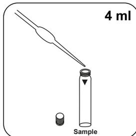
Adicionar **4 ml de amostra** à célula de amostra.
