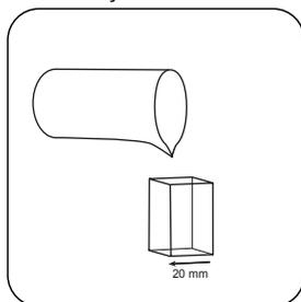
Encher a **célula de 20 mm** com **água desmineralizada**.
