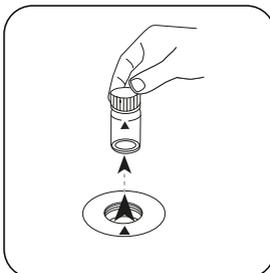
Prelevare la cuvetta dal vano di misurazione.
