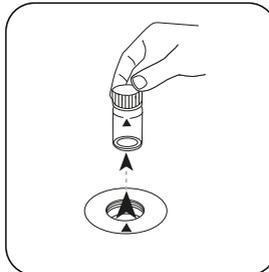
Prelevare la cuvetta dal vano di misurazione.
