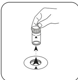
Prelevare la cuvetta dal vano di misurazione.
