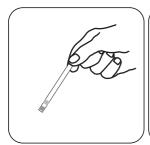
Einen Test Streifen der Verpackung entnehmen. Halten Sie das Ende des Teststreifens zwischen Zeigefinger und Daumen.
