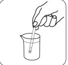
Tauchen Sie den Teststreifen so in die zu testende Lösung, dass alle Pads vollständig eingetaucht sind. (1 Sekunde)
