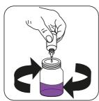
Ajouter Phosphonate Titrant P5 goutte à goutte à de l'eau traitée (résultat l'échantillon jusqu'à ce que la coloration passe du gris au violet.
