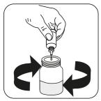
Ajouter Phosphonate pH Adjuster P3 goutte à goutte jusqu'à ce que l'échantillon soit incolore.
