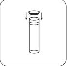
Chiudere la (le) provetta (provette).
